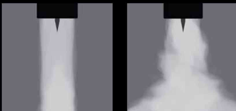
L'image de droite montre un flux très turbulent, offrant une protection médiocre et une importante consommation de gaz.
