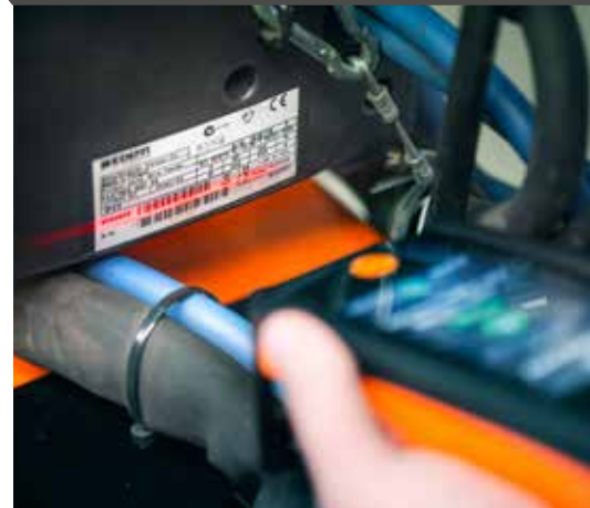
ArcValidator RC enregistre toutes les données individuelles du processus de validation pour les transférer ultérieurement au logiciel sur PC.
