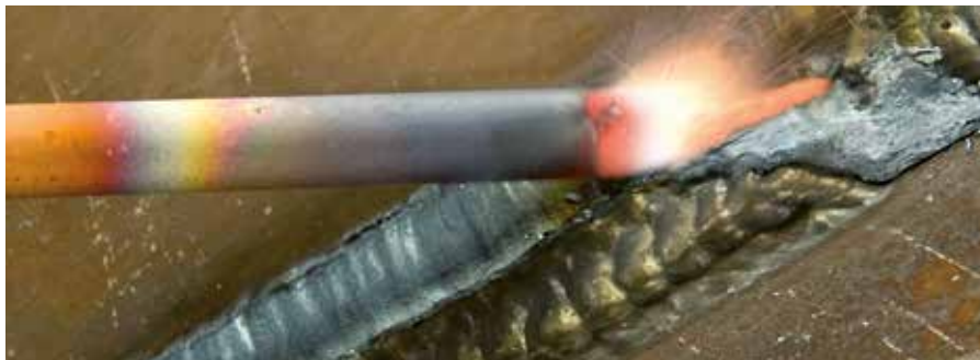
Le KempGouge ARC 800 facilite le travail de gougeage à l'arc de carbone.
