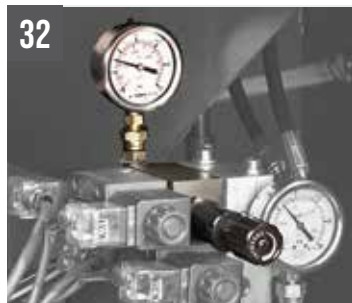
SHARK SXI evo Régulateur pression étau hydraulique
