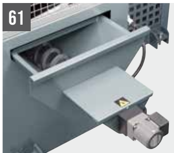
61 SHARK 230-1 / 331-1 NC 5.0 spider Evacuateur de copeaux motorisé à vis
