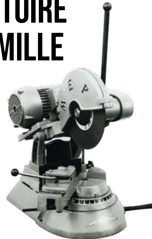
MEP TV 300 Le premier modèle de machine à tronçonner à disque abrasif construite en série
