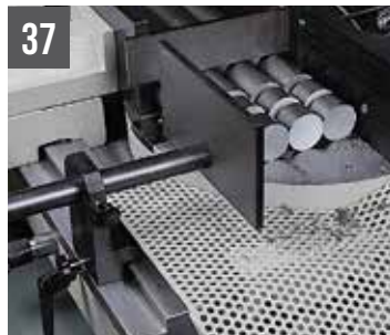
SHARK 282 NC 5.0 / 332-1 NC 5.0 Guide réglable pour la chute des pièces coupées
