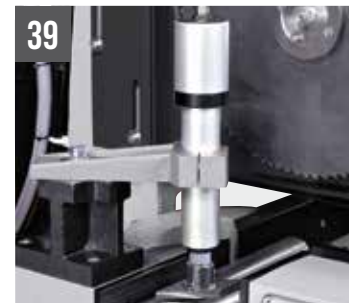
TIGER 352 MA/COBRA 352MA Étau vertical pneumatique
