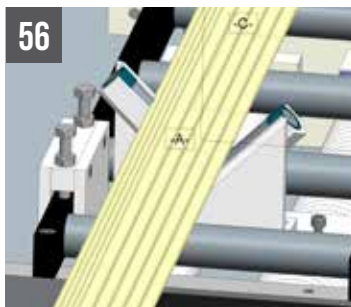
TIGER 372 CNC LR 4.0 - Guide réglable dans l'alimentateur pour mâchoires à peigne (la course maximale de l'alimentateur se réduit de 100mm)
