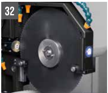
32 TIGER 372 CNC LR 4.0 (Ø max 105 mm) guidelame en carbure
