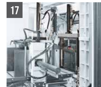
17 SHARK 350 NC HS 5.0 étaux verticaux hydrauliques pour coupe en paquets (max 350x350 mm)
