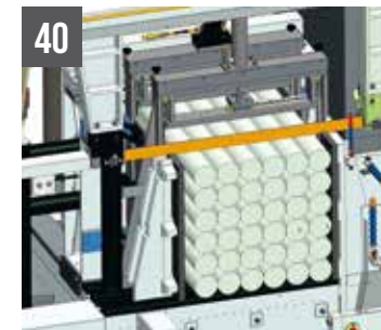
40 SHARK 660 CNC HS 4.0 étaux verticaux hydrauliques pour coupe en paquets (660 x 660 mm)
