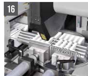
16 TIGER 402 CNC hs 4.0 - série de mâchoires à peigne en nylon 75x75 mm max.
