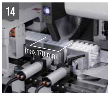
14 TIGER 402 CNC HR 4.0 - série de mâchoires à peigne 75x75 mm max. pour réduire la chute du matériau à couper
