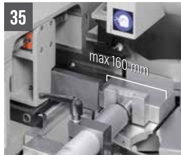
35 TIGER 402 CNC HR 4.0 - étai spécial pour réduire la chute
