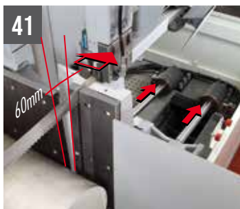
41 SHARK 660 CNC HS 4.0 recul de la mâchoire fixe de coupe
