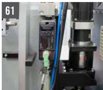
SHARK 460 KONNECT Dispositif écoulement du liquide de refroidissement têtes guidelame
