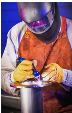
Associé aux torches aspirantes ABICOR BINZEL xFUME® TIG, le xFUME® ADVANCED est particulièrement efficace. Grâce à une coordination optimale, il assure une aspiration très efficace directement au niveau de la buse gaz permettant d'avoir aussi une vision claire de l'arc.
