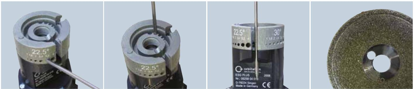
Affûtage des électrodes: 4 angles différents, 6 diamètres d'électrodes différents
