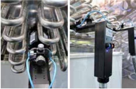
Conception extrêmement étroite - idéale pour le soudage de coudes pré-assemblés dans des faisceaux de tubes étroits.
