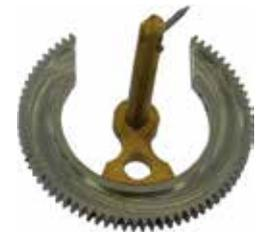
Adaptateur de soudage intérieur (sans rotor)
