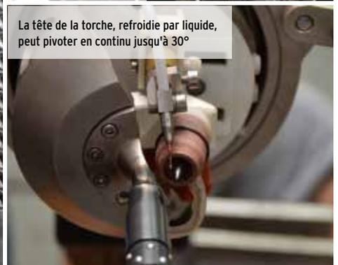
**Avec ces têtes de soudage TIG pour tubes au sol, souder des tubes dans des plaques tubulaires avec la plus grande précision et une qualité constante ne pose aucun problème.**
