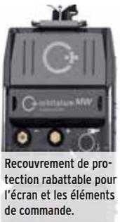
Recouvrement de protection rabattable pour l'écran et les éléments de commande.
