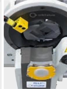
Deuxième attachement de lame de scie pour la désolidarisation par tronçonnage de coudes
