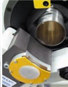
Principe de la coupe planétaire éprouvé : la lame de scie plonge dans la coupe et est guidée orbitalement autour du tube
