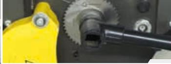
Mâchoires de serrage réversibles pour l'usinage de tubes à parois minces et épaisses (uniquement pour la GF 4)
