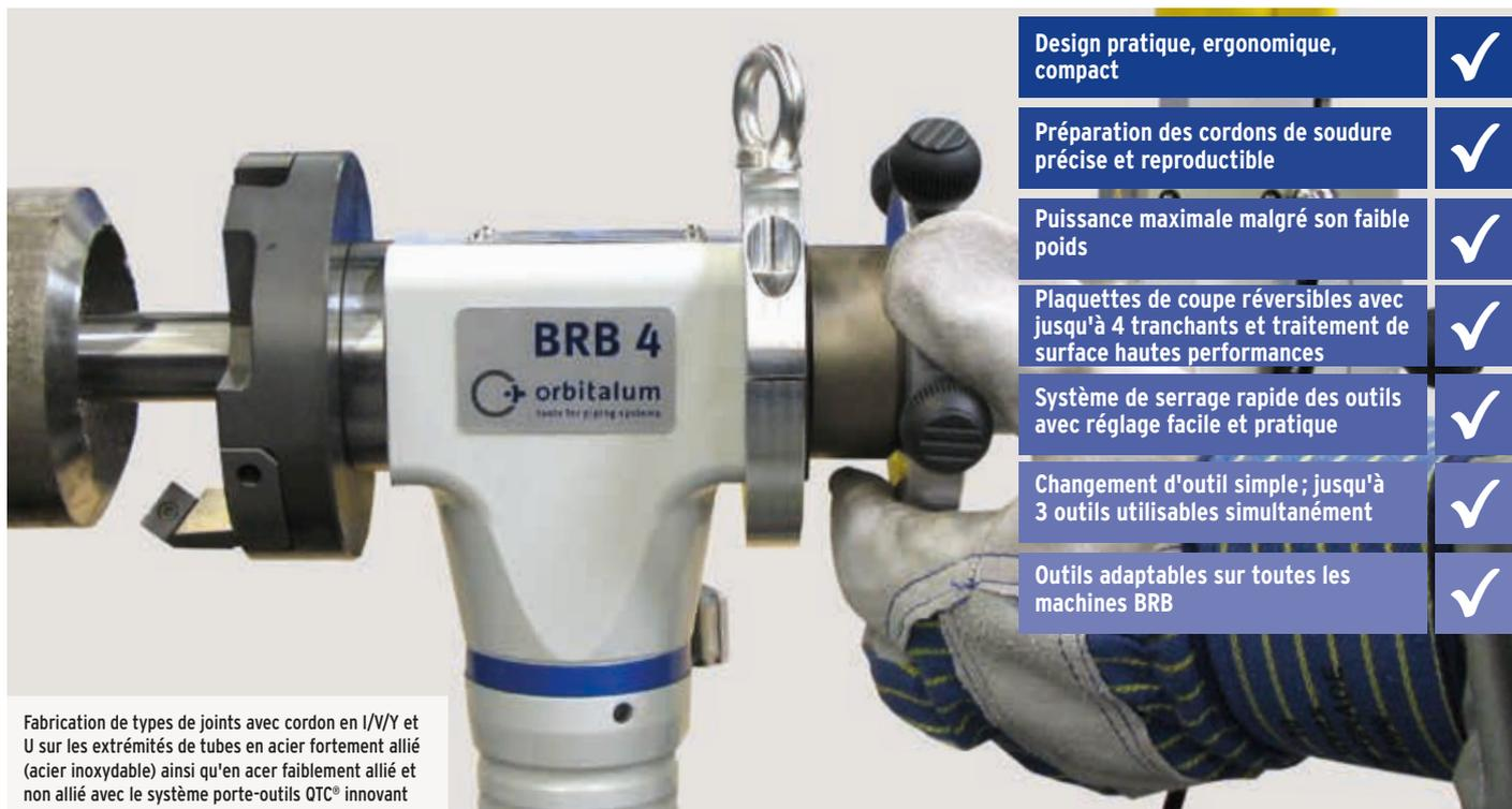
Fabrication de types de joints avec cordon en I/V/Y et U sur les extrémités de tubes en acier fortement allié (acier inoxydable) ainsi qu'en acier faiblement allié et non allié avec le système porte-outils QTC® innovant
