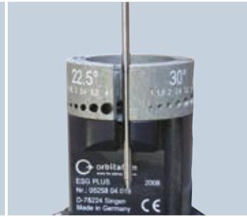
Coupure à longueur des électrodes
