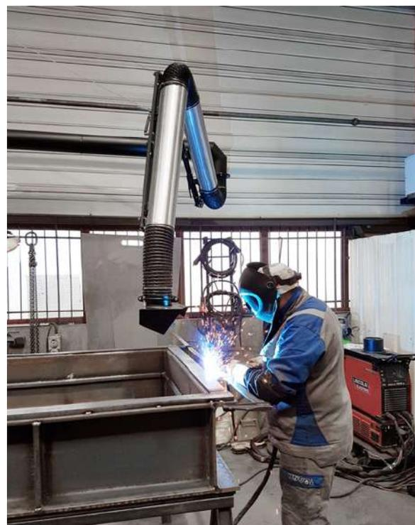
*Bras ARMOWELD et capteur laminaire REVOLFLOW*
