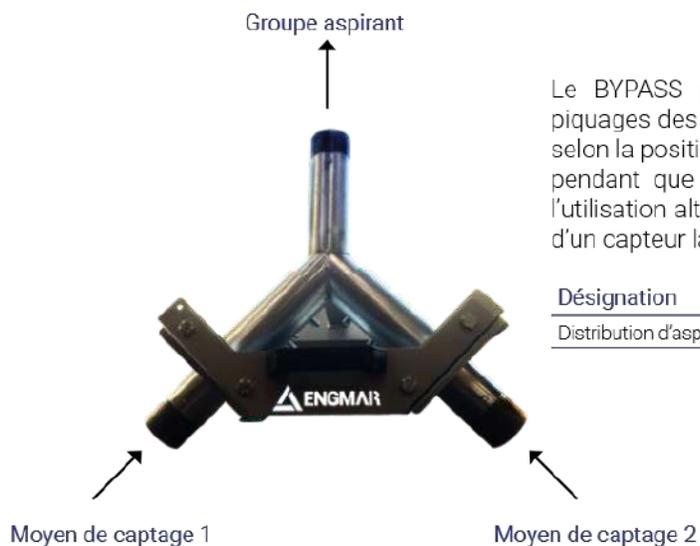
Le BYPASS permet de distribuer l'aspiration entre les deux piquages des groupes double entrée. L'aspiration fonctionne alors selon la position du BYPASS uniquement sur une des deux entrées pendant que l'autre entrée est fermée. Il permet par exemple l'utilisation alternée d'une torche aspirante MIG/MAG **ENGMAR** et d'un capteur laminaire **ENGMAR** sur un même groupe aspirant.
