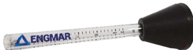
Le contrôleur de débit permet de vérifier de façon instantanée le volume de gaz de protection à la buse de gaz. Un débit gaz excessif génère le soufflage des fumées en dehors du champ de captage des torches. Le débit de gaz doit être proportionnel au diamètre de la buse à gaz : 1 l/min pour 1 mm de diamètre. Par exemple : 14 l/min pour une buse à gaz de diamètre 14 mm.
