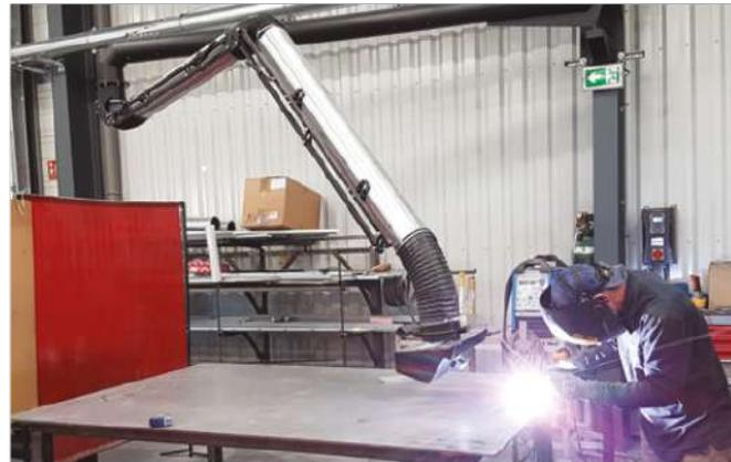
La structure porteuse extérieure, réalisée en une seule pièce, est fabriquée en acier et en alliage anodisé pour garantir la résistance dans le temps malgré l'exposition continue aux fumées et pour augmenter la légèreté de l'ensemble.
