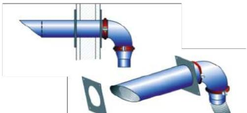
Les kits d'évacuation sont conçus pour rejeter les fumées captées par les groupes aspirants autonomes vers l'extérieur. Le refoulement s'effectue en bardage. Les kits s'entendent hors supportage, qui est disponible sur demande. Diamètre de la cheminée 80 mm, diamètre connexion d'aspiration 60 mm avec cône(s).
