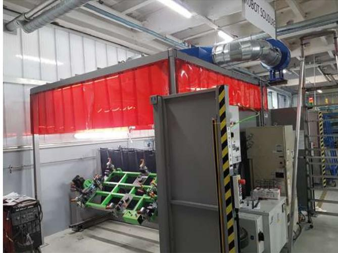
**ENGMAR** développe et installe des structures intégrant des capteurs laminaires ou des hottes pour isoler la zone de soudage.
