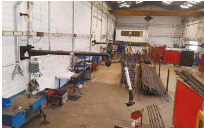
Les bras sont livrés avec un support mural pour la fixation et le raccordement à la tuyauterie d'extraction des fumées. Les consoles murales de fixation permettent également la mise en place de moto-ventilateurs. Les bras sont livrés sans hotte.
