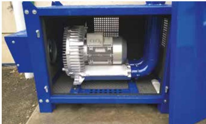
**Filtration :** dépoussiéreur à cartouches à décolmatage pneumatique. Surface filtrante de 40 à 50 m<sup>3</sup>/h par m<sup>2</sup> (pour 1000 m<sup>3</sup>/h effectif : surface de 25 m<sup>2</sup>). Média filtrant en polyester traité pour efficacité de l'ordre de 99% sur les particules de 1 µm et plus.
