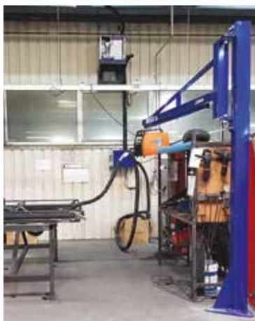
Les potences SIMPLAXE sont composées d'un simple pivot avec un support pour dévidoir, d'un poids maximum de 50kg, sur rail. Le rail est équipé de galets et de chariots de fixation 255 A permettant la fixation du faisceau de puissance ainsi que du flexible d'aspiration.
