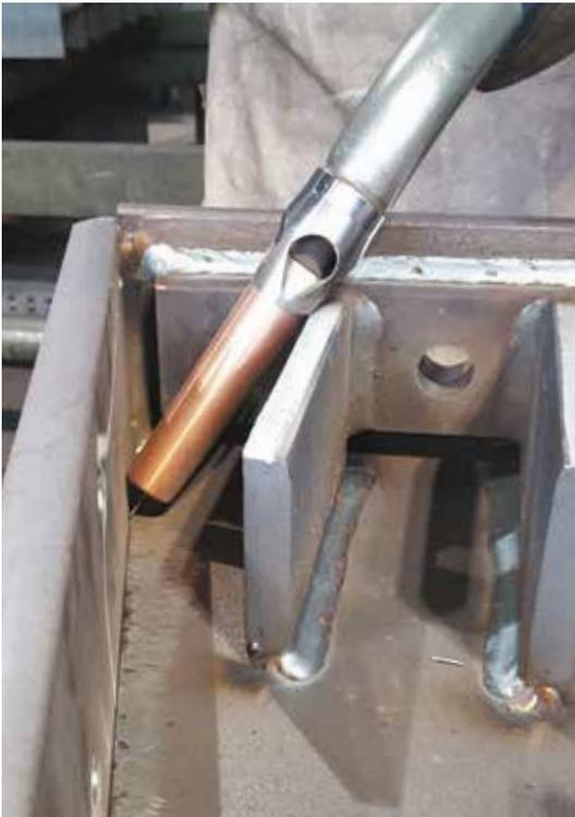
Les buses gaz longues pour torches 300, 350 et 380 permettent l'utilisation même dans les endroits les plus confinés. Elles mesurent 4 cm de plus que les buses à gaz standard.
