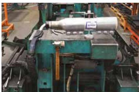
Le gabarit de contrôle pour torches **ENGMAR** permet de mesurer et surveiller le débit et la vitesse en tête de torche.
