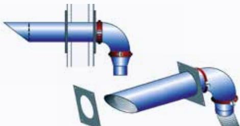
Les kits d'évacuation sont conçus pour rejeter les fumées captées par les groupes aspirants autonomes vers l'extérieur. Le refolement s'effectue en bardage. Les kits s'entendent hors supportage, qui est disponible sur demande. Diamètre de la cheminée 80 mm, diamètre connexion d'aspiration 60 mm avec cône(s).
