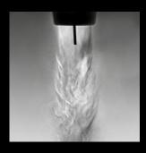
Le débit de gaz de protection a un impact important sur la qualité de soudage. Normalement, le gaz de protection est invisible, mais grâce à la technologie d'imagerie Schlieren, il est possible d'observer le débit de gaz réel. Cette technologie illustre de quelle façon le design de la torche de soudage et les consommables Flexlite GX permettent un flux de gaz laminaire ainsi qu'une meilleure couverture du gaz de protection.
