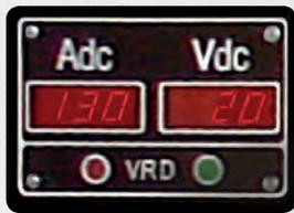
DSP Voltmètre/Ampèremètre de soudure et voyant indicateur VRD
