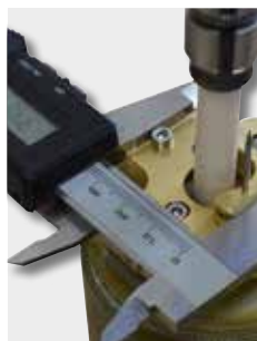
Réglage simple et précis de la position de l'électrode
