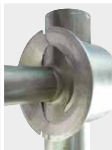
Coquilles de serrage en T avec possibilité de positionner le tube extrudé et le tube à souder
