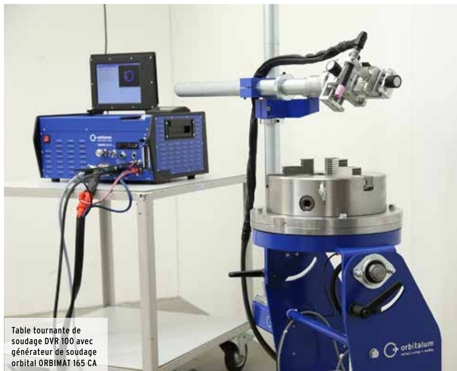
Mandrin à trois mors pour un positionnement et une fixation exacts de la pièce à souder
