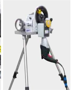
Trépied en aluminium disponible en option. Démontable en quelques étapes - pour un rangement gain de place p.ex. dans la caisse de transport PS
