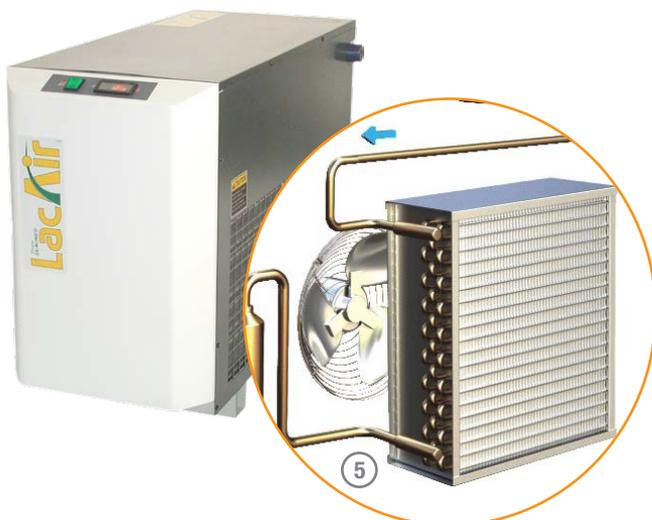
Les sécheurs, à partir du modèle SH14 sont des **sécheurs à grande capacité (> 140 m<sup>3</sup>/h)**, de ce fait, ils ne peuvent pas utiliser la technologie du condenseur statique (grille) pour refroidir le gaz réfrigérant, sinon ils seraient beaucoup trop volumineux.
