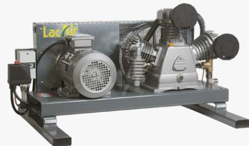
Pour être posée au sol avec plus de stabilité et moins de vibrations, la platine doit être mise sur des supports spécifiques.
