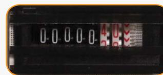
Les compresseurs SILENT sont tous équipés de série d'un compteur horaire électromécanique, placé en façade avant, pour connaître en temps réel leur nombre d'heures de fonctionnement et ainsi planifier leur entretien.
