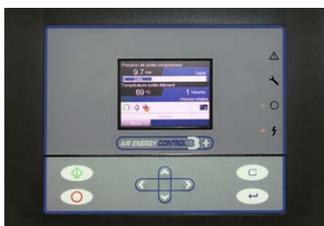
Donne facilement accès à différents menus tels que : **réglage de l'horloge (date et heure), réglage heure de démarrage et d'arrêt automatique (quotidien, hebdomadaire ou mensuel), réglage des pressions mini ou maxi, ré-initialisation des alarmes : température, thermique moteur, température ventilateur, inversion de rotation, pression élevée...** Interface graphique sur Air Energy Control 3+ (vis 25, 30 et 40 CV).
