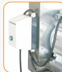
Les compresseurs de grosses puissances sont équipés de série d'un boîtier de commande.
