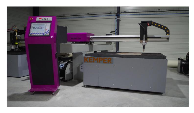
Particulièrement pensée pour les utilisateurs disposant d'une surface réduite, la construction en potence de **Axxia** permet d'optimiser la surface d'atelier.
