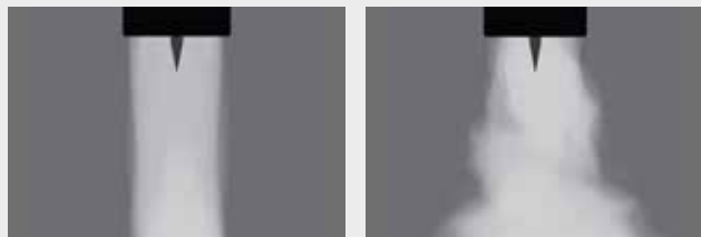
L'image de droite montre un flux très turbulent, offrant une protection médiocre et une importante consommation de gaz.
